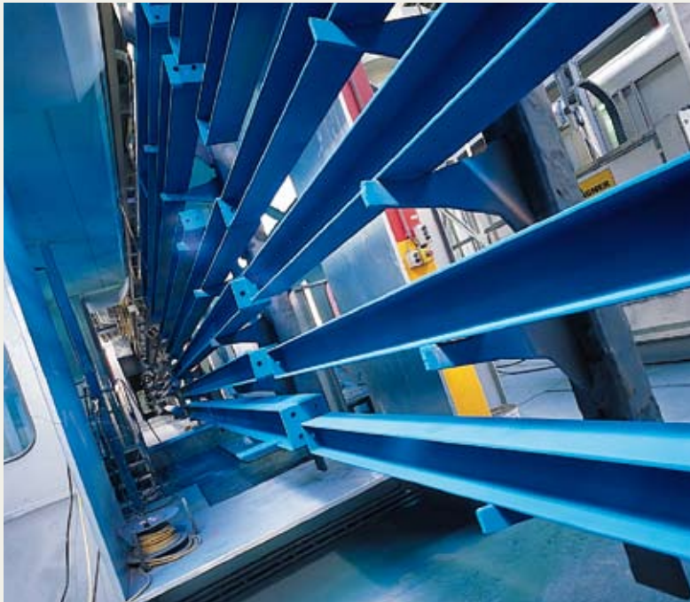
▲ Diese Stahlbauteile wurden für ein Schwimmbad beschichtet. Hier galt es, mit reduzierten Einbrenntemperaturen hohe Korrosionsschutz-Anforderungen zu erfüllen.
