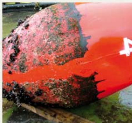
◀ Im Außeneinsatz müssen Pulverbeschichtungen teilweise extremen Beanspruchungen widerstehen. Links: Pulverlackierter Eingangsbereich einer Windenergieanlage. Rechts: Pulverbeschichtete Boje
